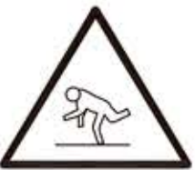
CAIDAS AL MISMO NIVEL
