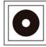
R. PULSADOR DE ALARMA
