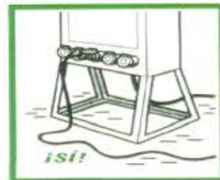
Hay que proteger al máximo las canalizaciones eléctricas contra los riesgos de aplastamiento, ciñadura, cortes, etc... Debe remplazarse todo cable estropeado.
