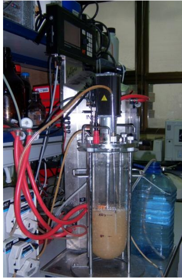
Fig. 2.8. SBR operado bajo condiciones aeróbicas de alimentación dinámica alimentado con medio sintético.
