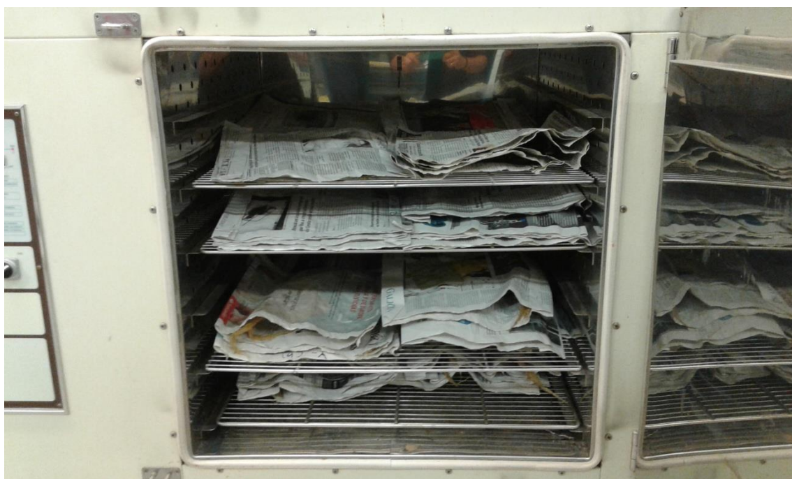
Figura 5. Material vegetal secando en la estufa a 80°C durante 72h.
