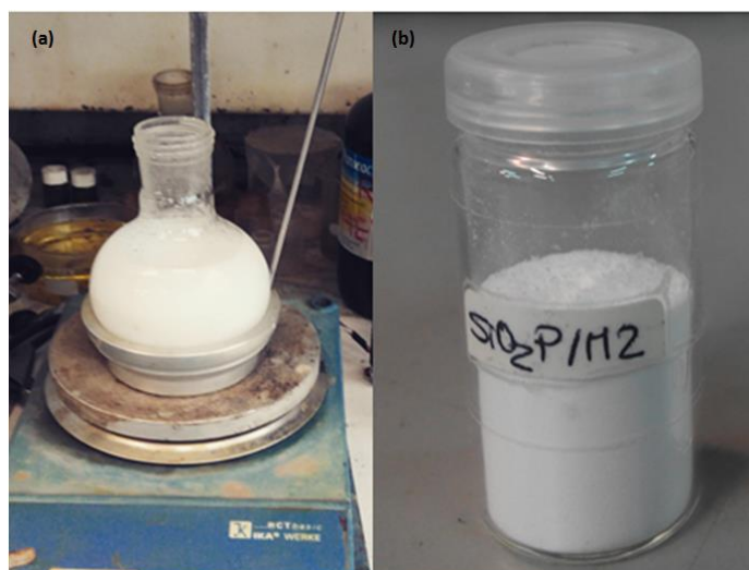
Figura 21: (a) Reacción de obtención de sílice mesoporosa. (b) Producto final de la síntesis.
