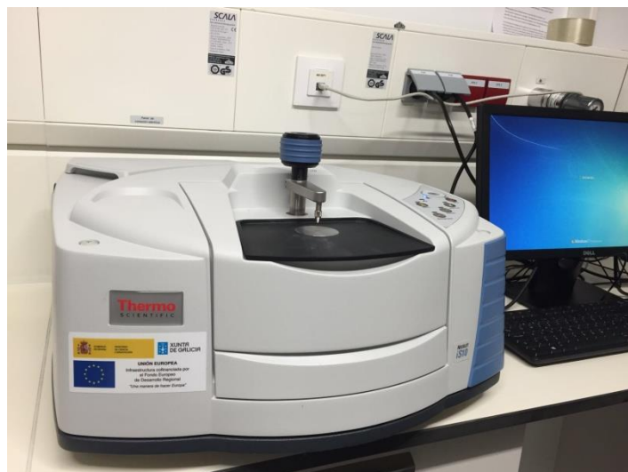
Figura 25: Espectrofotómetro Thermo Scientific Nicolet iS10 con módulo FT-IR Thermo Scientific™ Nicolet iZ™10 externo
