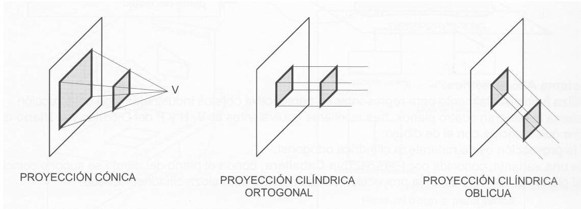
Figura 1.1.- Proyección cónica, cilíndrica ortogonal y cilíndrica oblicua. Imagen extraída de Giménez Peris (2014).
