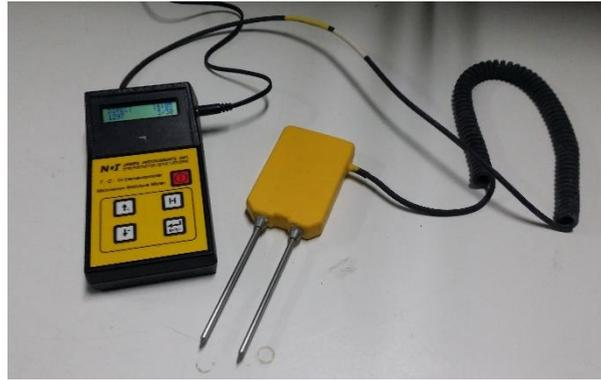
Figura 4.5. Cementómetro con sonda
