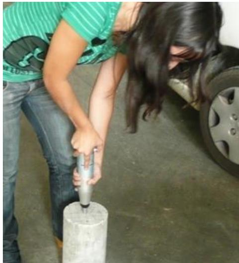
*Figura 4.2. Ensayo para medición de índice de rebote*
