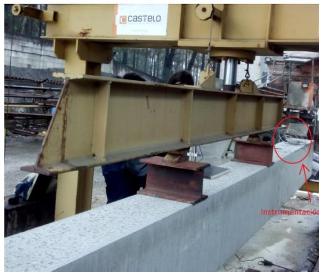
Figura 8.52. Viga de sección rectangular instrumentada con sensor de temperatura interna
