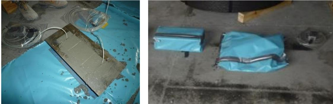
Figura 8.49. Probetas curadas en el mismo ambiente que el muro
