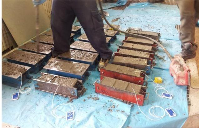
*Figura 4.7. Amasada base durante el vibrado*
