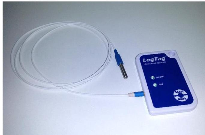
Figura 4.6. Registrador de temperatura interna y sensor LogTag
