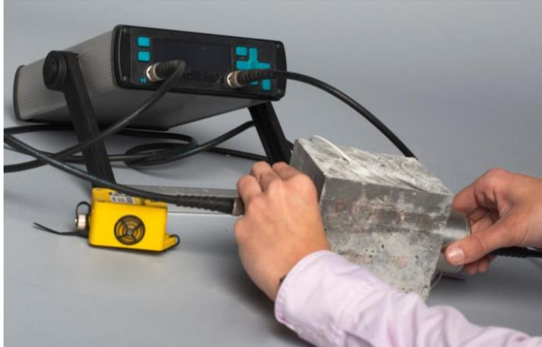
*Figura 4.1. Ensayo para medición de velocidad de ultrasonidos*
