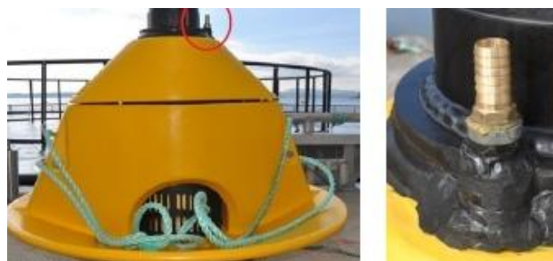
Ilustración 75. Distribución del aire en la cabeza de succión.
