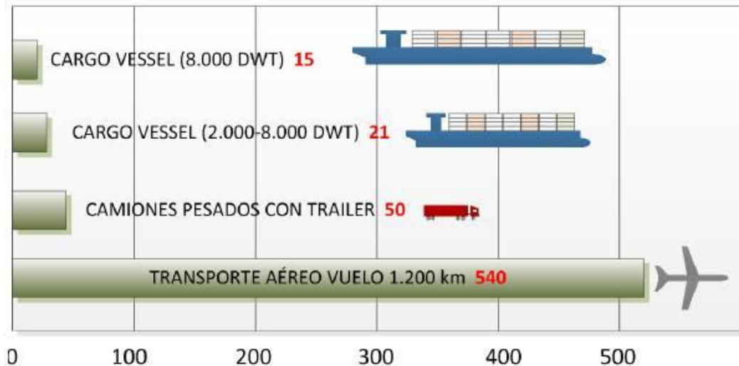
Figura 1.2: Comparativa entre las emisiones específicas del transporte marino con otros medios de transporte expresado en gramos CO 2 por tonelada-km.
