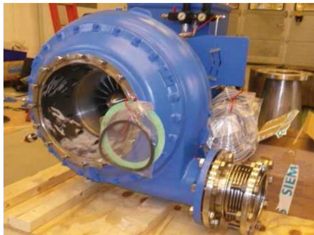
Figura 6.9.1: EGR 'blower' empleado para el sistema EGR del motor 4T50ME-X de MAN
