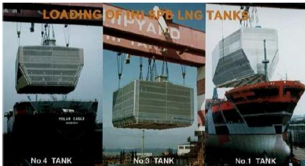
Figura 4.7.1.1: Diseño del tanque tipo 'B' por la casa IHI
