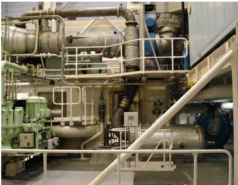
Figura 6.3.2: Sistema EGR del motor 4T50ME-X de MAN
