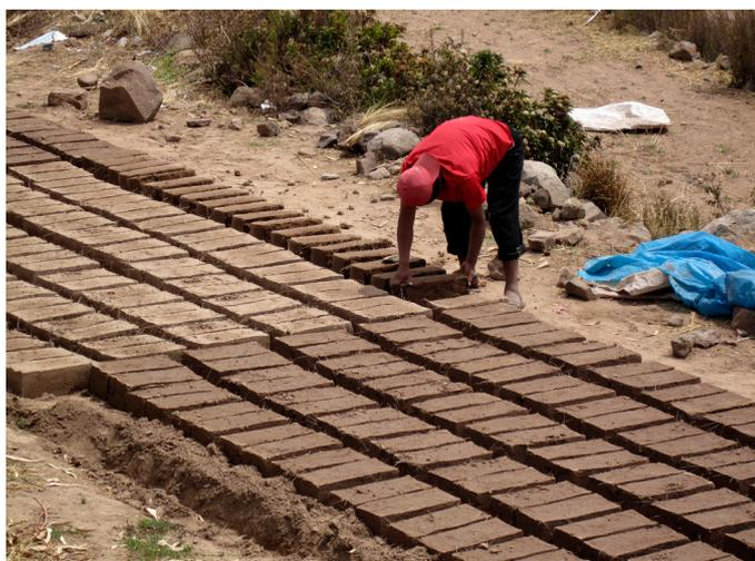
Fig. 3.1.02. Cocción al sol de ladrillos de adobe en la isla de Taquile. Lago Titicaca, Perú.
