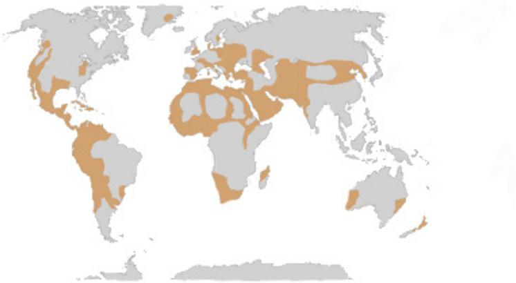
Fig. 3.1.01. Expansión de la técnica de la construcción con tierra cruda.
