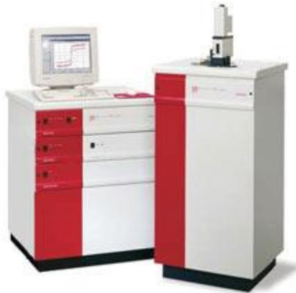
Figura A-20 Magnetómetro SQUID MPMS XL de Quantum Design
