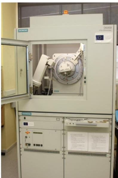
Figura A-7 Goniómetro del difractómetro Siemens D-5000
