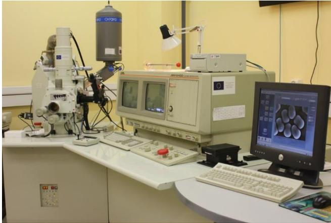
Figura A-5 Microscopio electrónico de barrido JEOL JSM 6400
