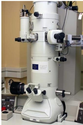
Figura A-6 Microscopio electrónico de transmisión JEOL JEM-1010
