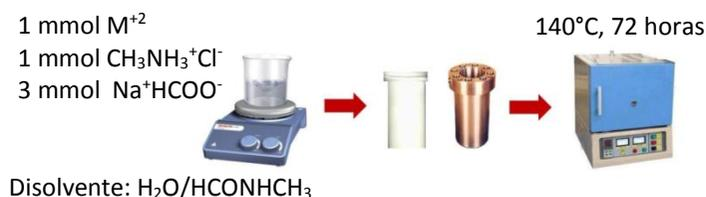
Figura 3-1 Resumen del procedimiento empleado para la síntesis de  $[CH_3NH_3]M(HCOO)_3$
