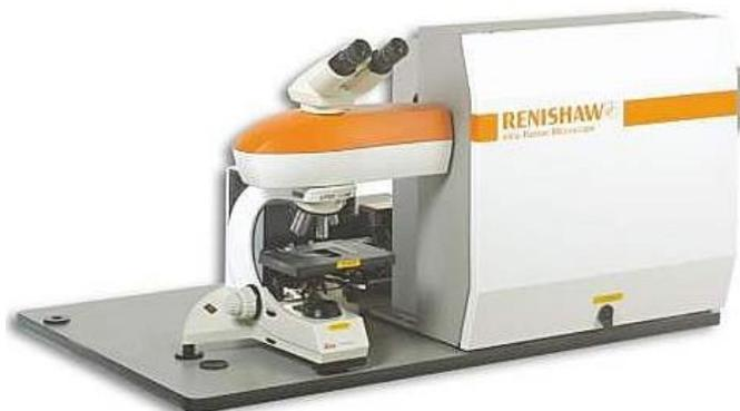
Figura A-9 Espectrómetro confocal Resnishaw Raman “Invia Reflex”.
