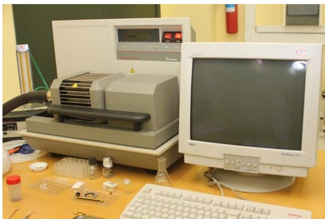
Figura A-11 Analizador simultáneo ATD-ATG SDT2960 de TA Instruments
