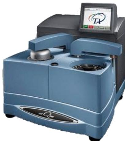
Figura A-12 Equipo de DSC modelo Q-2000 de TA Instruments.
