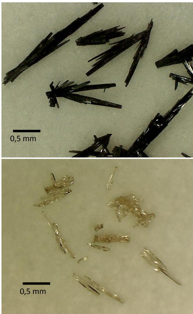
Figura 2-23 Fotografías de  $[M_2(NH_2-bdc)_2(dabco)][G]$  con  $M = Co^{+2}$  (superior) y  $Zn^{+2}$  (inferior)
