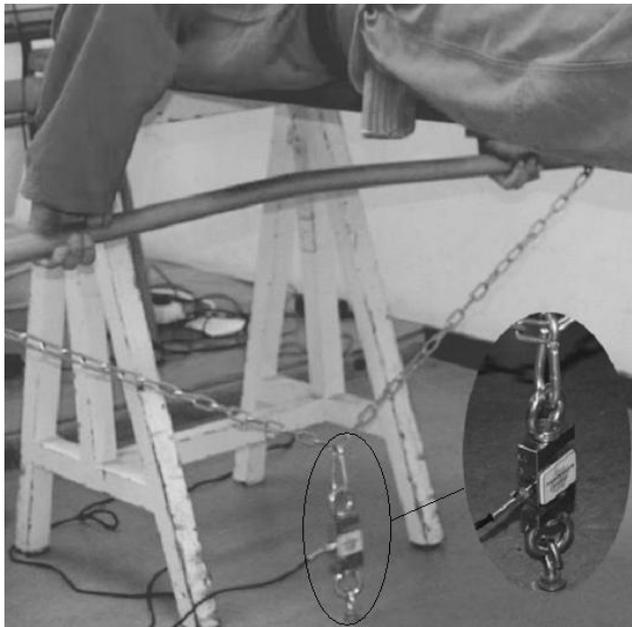
**Figura 26.** Imagen del sistema de medición de la fuerza isométrica del miembro superior. Se destaca el anclaje del transductor extensiométrico (MuscleLab Force Sensor).
