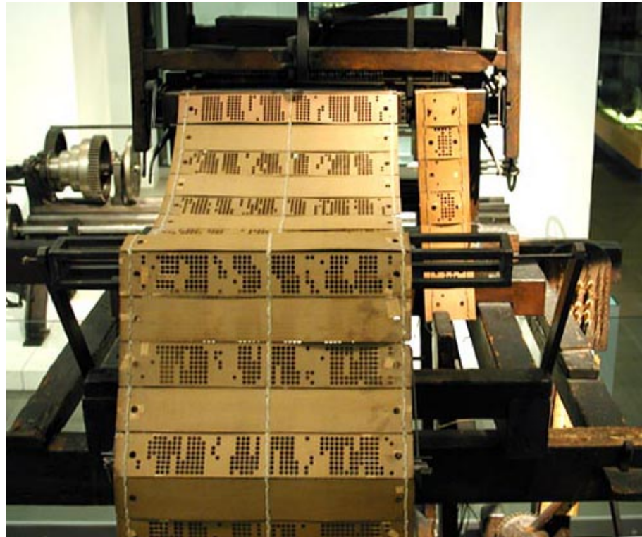
Ilustración 17. Sistema de tarjetas en el telar de Jacquard, 1810.
