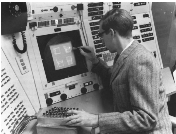
Ilustración 52. Ivan SUTHERLAND utilizando el programa Sketchpad en la consola TX-2 en el Lincoln Laboratory del MIT, 1963.
