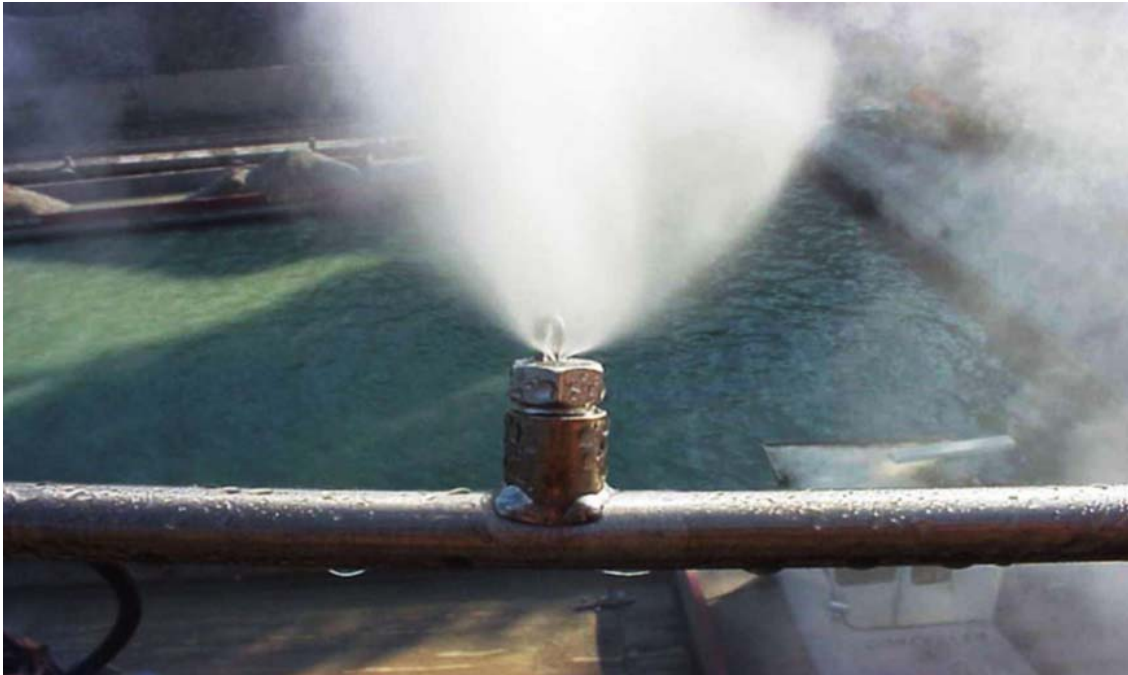
Ilustración 56. DILLER + SCOFIDIO, Blur Building , Microdifusor Tipo 1, test de niebla, 1999.
