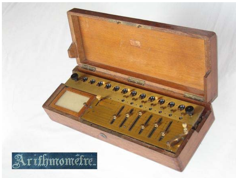
Ilustración 15. Aritmómetro de Colmar construido por Louis Payen en 1887.
