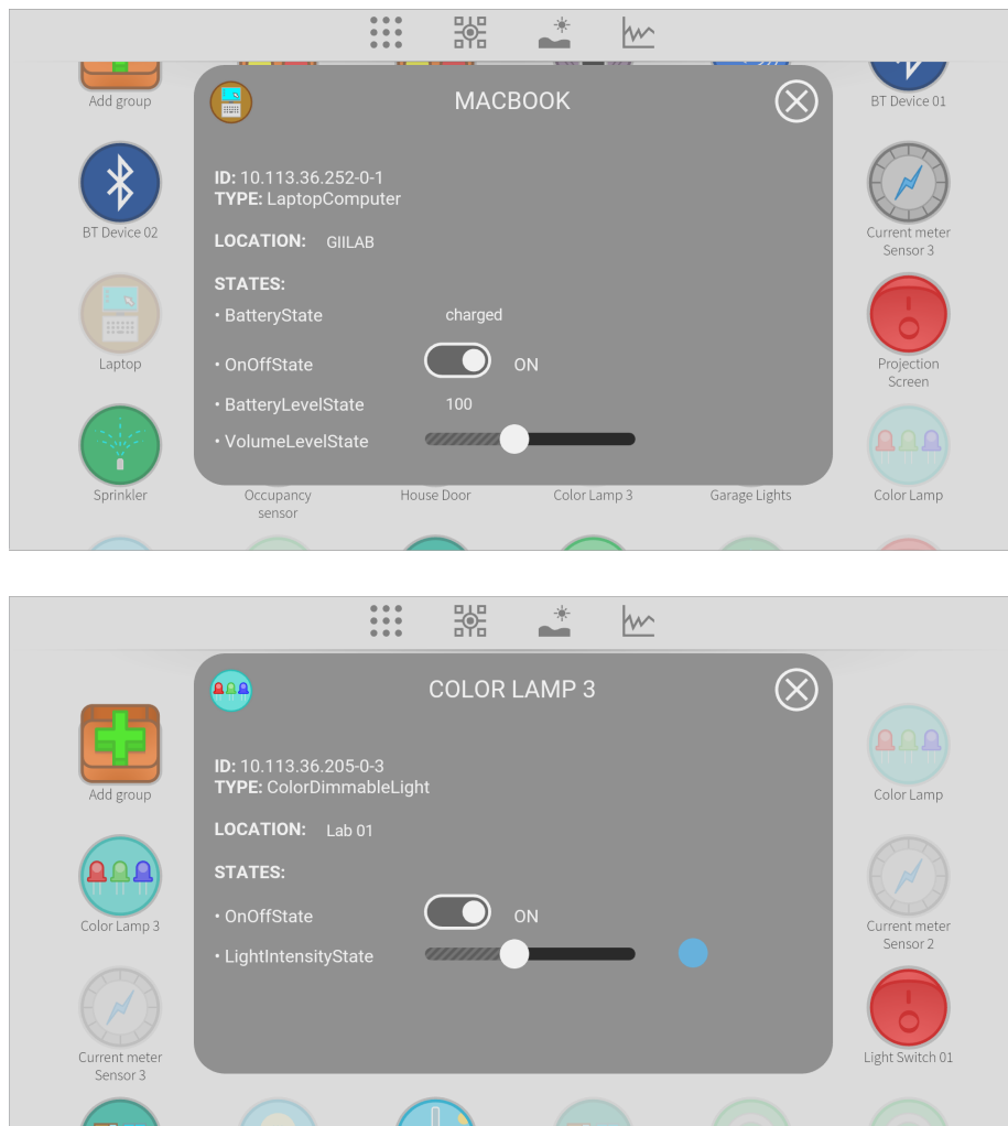
Figura 8.5: Capturas de pantalla de la aplicación Entorno-Conectado en la que se muestra la información detallada en tiempo real de dos dispositivos del entorno, a la vez que se permite actuar sobre sus estados modificables.
