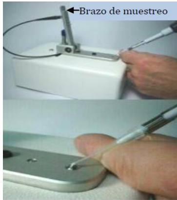
Figura 7. Espectrofotómetro NanoDrop 1000. Tomada de Thermo Scientific (2015).
