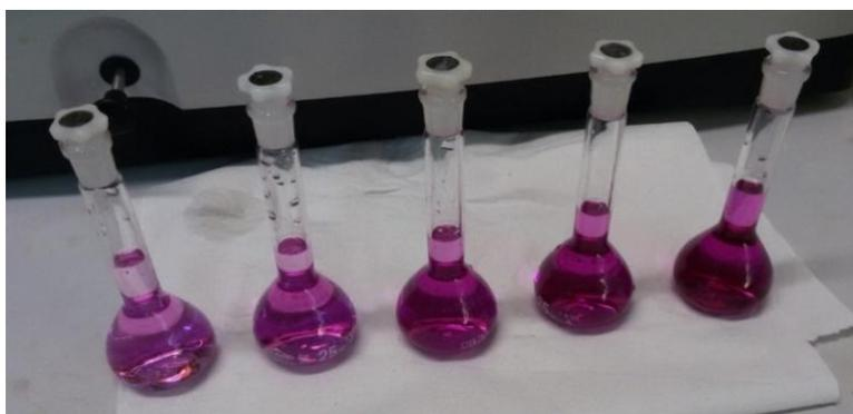
Figura 19: Patrones de calibrado para la determinación de Cr(VI) por colorimetría.
