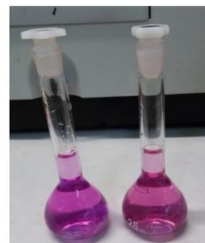
Figura 20: Cambio de coloración en presencia de Fe(II) 0.8 ppm.
