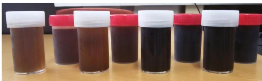
**Figura 29:** Disoluciones de nanopartículas obtenidas con los extractos vegetales de tojo, pino, castaño y roble (izq. a dcha.) en agua (tapón blanco) y en la mezcla agua/ETOH (tapón rojo).
