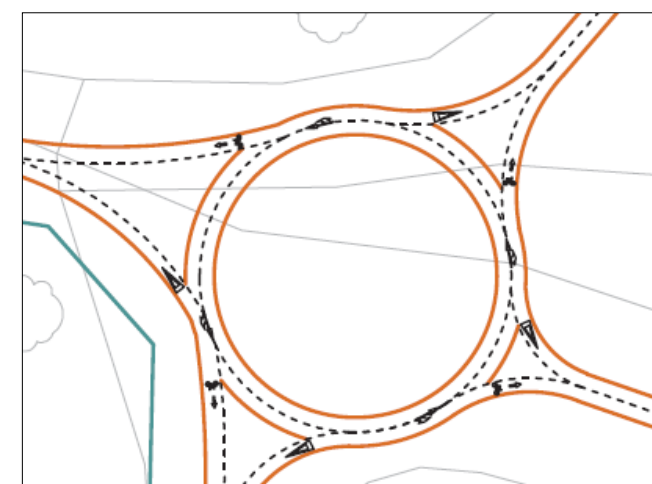
Figura 6. Rotonda de unión de las vías ciclistas en zona no urbana.
