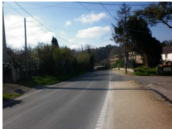
**FOTO 9:** Tramo en mal estado debido al reducido ancho de calzada y acera. Ambas se ampliarán hacia el margen izquierdo.
