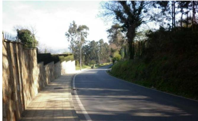
**FOTO 20:** Acera en buen estado en margen derecho y por el izquierdo se requiere desmonte del talud para ampliar la calzada y realizar la senda
