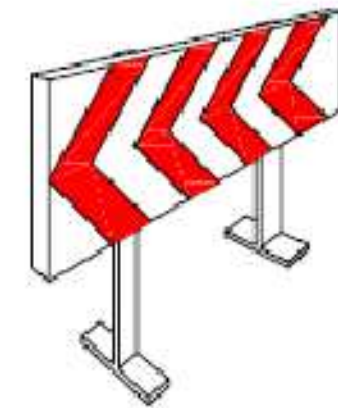
BALIZAMIENTO DE GÁLIBO DE OBRA
