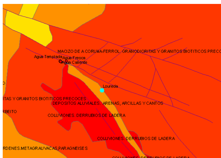
Figura 306. Alumbramientos del balneario de Loureda (en azul). Se muestra la geología de superficie.
