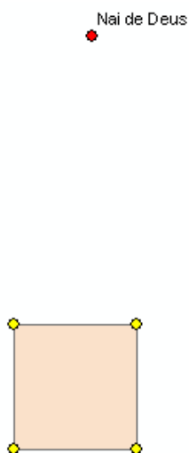
Figura 33. Detalle del mapa en GIS georreferenciado al Datum ETRS89 UTM Zone 29N. En él se han representado las coordenadas de los vértices del perímetro de protección del Balneario del Río Pambre correspondientes a la Zona de Máxima Protección (ZMA) y del alumbramiento. El perímetro de protección ZMA se encuentra desplazado respecto al alumbramiento.
