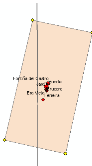
Figura 29. Detalle del mapa en GIS georreferenciado al Datum ETRS89 UTM Zone 29N. En él se han representado las coordenadas de los vértices del perímetro de protección del balneario de Cuntis correspondientes a la Zona de Máxima Protección (ZMA) y de los alumbramientos.
