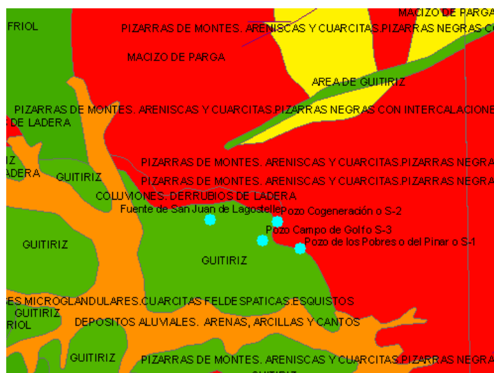
Figura 303. Alumbramientos del balneario de Guitiriz (en azul). Se muestra la geología de superficie.
