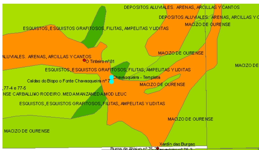
Figura 308. Alumbramientos del balneario da Chavasqueira (en azul). Se muestra la geología de superficie.
