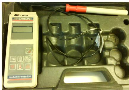
Figura 11: Conductivímetro
