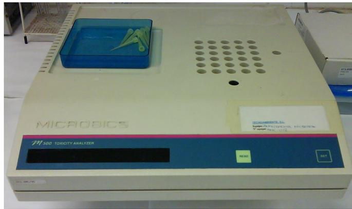
Figura 7: Analizador Microtox
