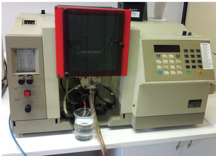
Figura 16: Espectrofotómetro de absorción atómica
