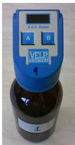
Figura 17a: Sistema sensor DBO<sub>5</sub>
