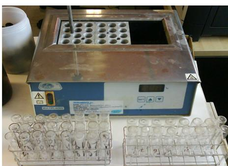
**Figura 13:** Bloque termostático metálico y tubos de la DQO
