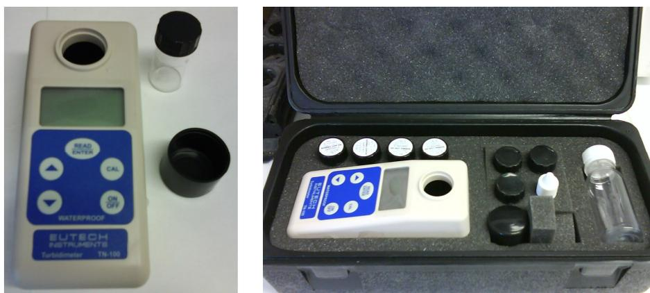
Figura 26: Turbidímetro portátil.
