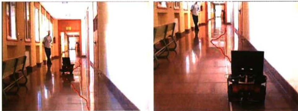
Figura 59: Comportamiento de seguir paredes modulado por la luz ambiente para el Pioneer 2-DX. La línea roja muestra la trayectoria seguida por el robot.
