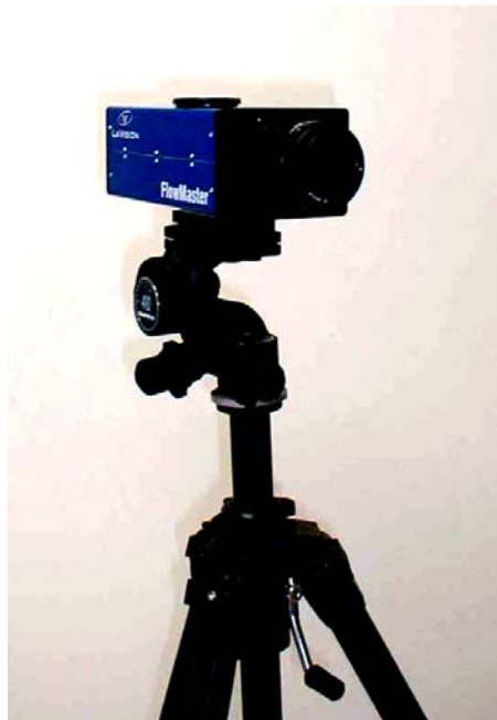
Figura 3.51. Detalle de la cámara CCD FlowMaster 3S© empleada en los experimentos.
