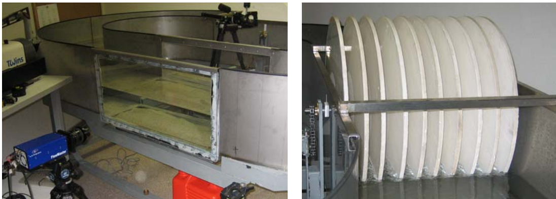
Figura 4.42. Vista general de canal y detalle de las ruedas motrices.
