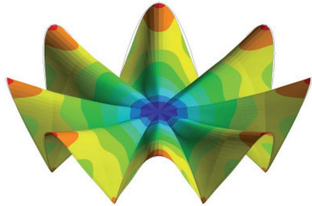
8 Félix Candela Outeiriño, Restaurante Submarino en el Parque Oceanográfico Universal (Valencia, 1999). Modelo de la cubierta laminar definida por la intersección de paraboloides hiperbólicos.
