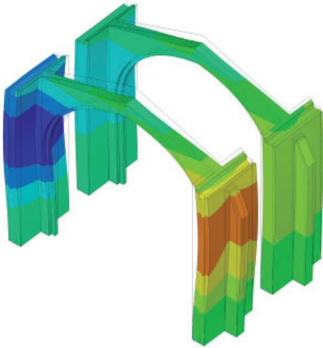
9 Modelo tridimensional que ilustra las deformaciones originadas en un arco fajón por falta de traba con hoja exterior y contrafuerte, unida a la progresiva de-gradación de los rellenos internos del muro compuesto.
