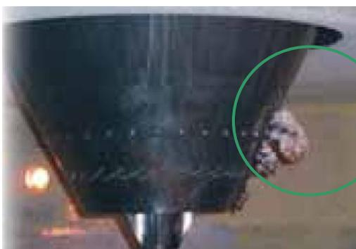
Proceso de autocombustión en un atomizador de leche en polvo
