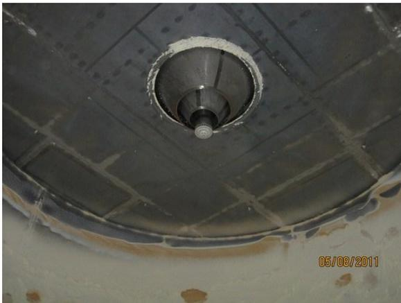
Foto 6.1. Atomizador de la cámara de secado
