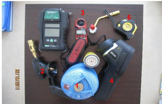
**Foto 8.36.** Elementos utilizados en el experimento (1-botella de 0,5 kg de butano, 2- cabezal de soplete para acoplar en la botella, 3-termohigrómetro kestrel k3000 para medir la velocidad de escape del gas, 4-cámara termográfica FLIR E60 y 5-flexómetro)
