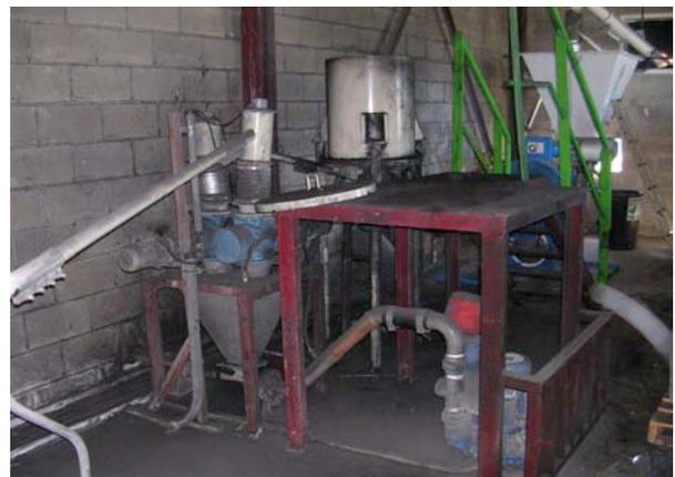
**Foto 9.14.** Sistema de dosificación de carbón
