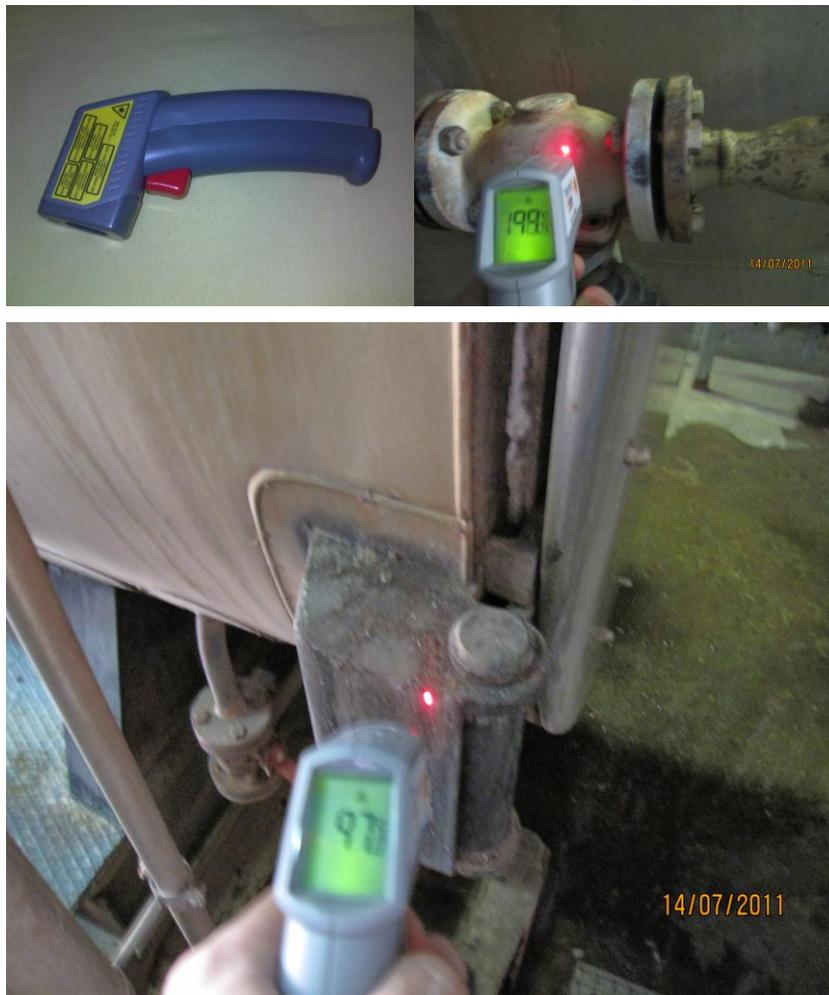
**Fotos 3.4, 3.5 y 3.6.** Pistola Thermofix y valores de temperatura superficial en válvula y bancada en la zona de calderas de EUROSERUM IBÉRICA, S.L.
