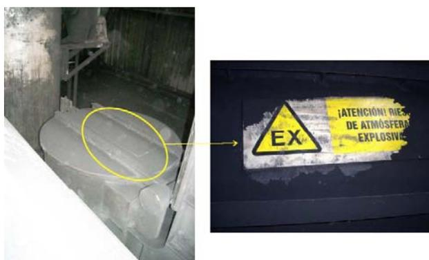
Foto 3.2. Falta de limpieza en dispositivo (De Gea)
