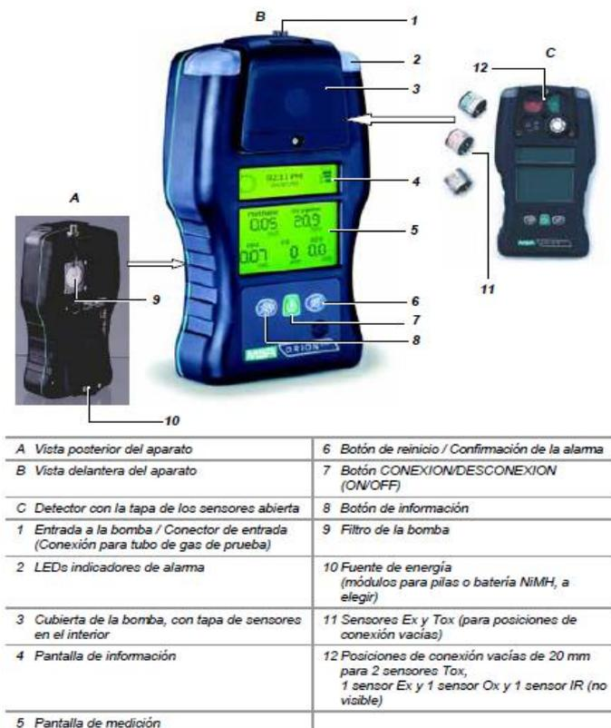
Figura 5.5. Vista del equipo de detección de gases Orion<sup>plus</sup>
