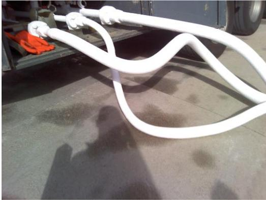
Fotos 8.54 y 8.55. Mangueras de descarga de gas durante el proceso de descarga
