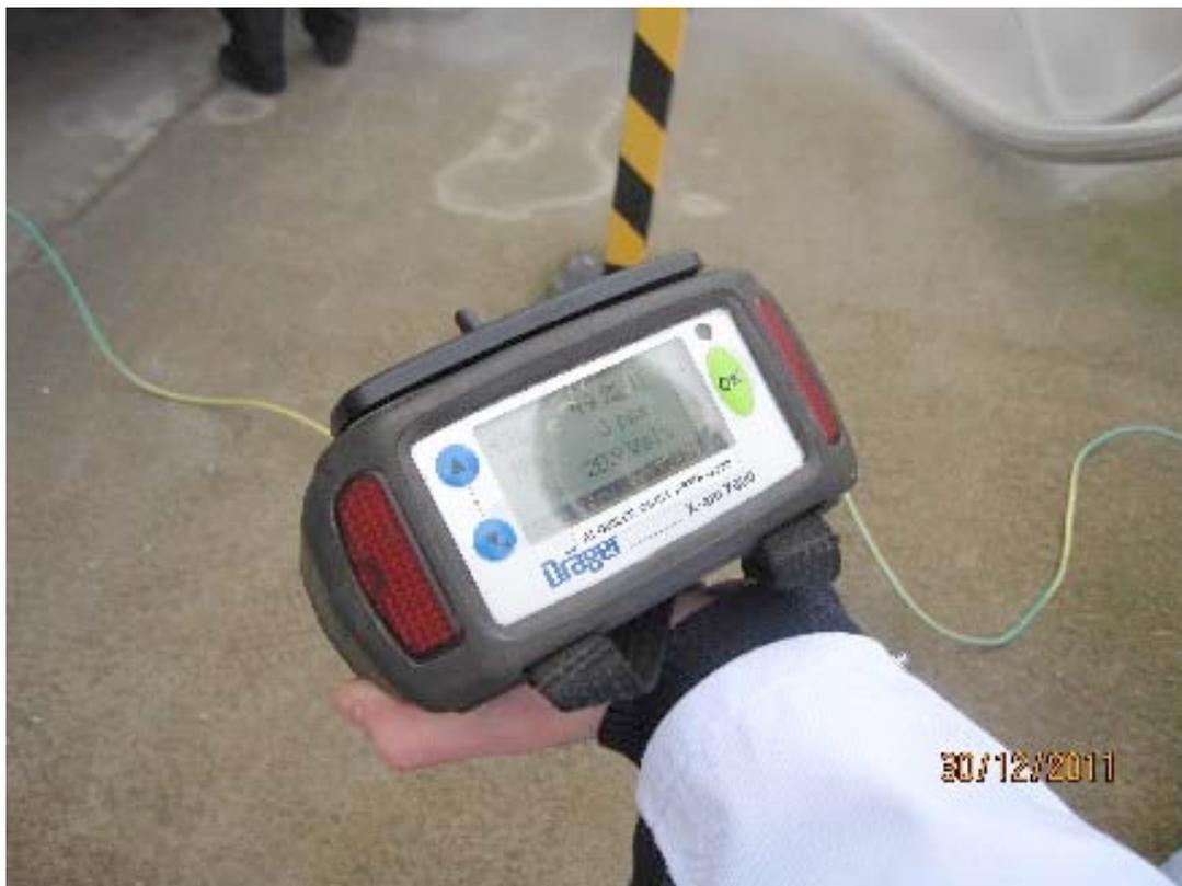
**Foto 10.3.** Valor recogido por el explosímetro para el metano
