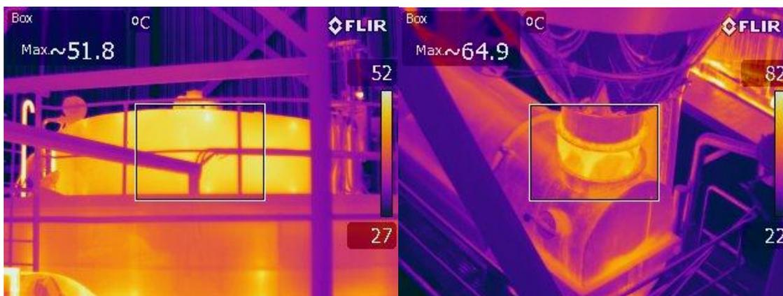
Fotos 7.2 y 7.3: imágenes termográficas; izquierda: parte superior de la cámara de secado, derecha: pico del silo de la cámara-entrada al vibrofluidificador
