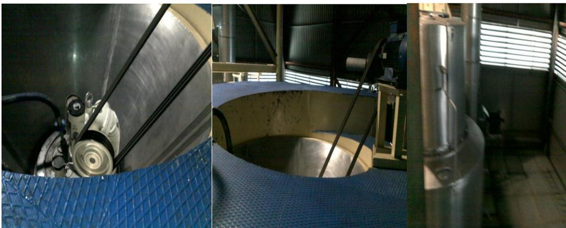
**Fotos 4.56, 4.57 y 4.58 (izquierda-dcha).** Correas del sistema atomizador en la parte superior del silo (fotos 4.56 y 4.57) y silo secundario de calentamiento (foto 4.58)
