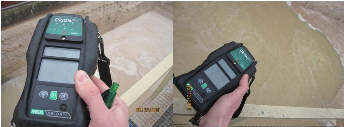
Fotos 5.4. y 5.5. Mediciones de gases en las balsas de aireación
