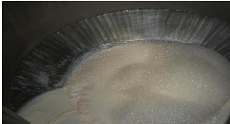
Foto 4.11. Separación de la nata de la leche en la higienizadora-desnatadora
