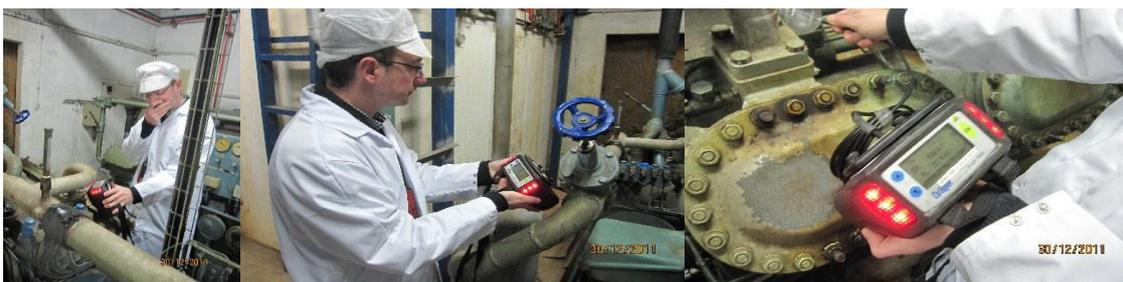
**Fotos 8.66, 8.67 y 8.68.** Mediciones de amoniaco con explosímetro en sala 2
