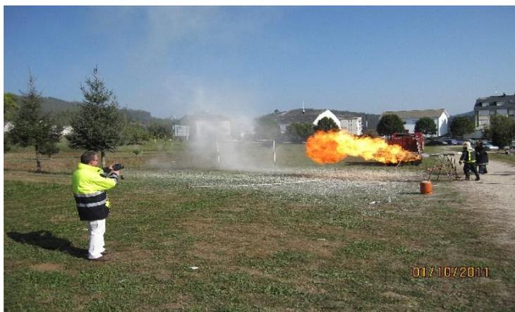
**Foto 8.51.** Grabación del proceso de combustión mediante la técnica de la termografía
