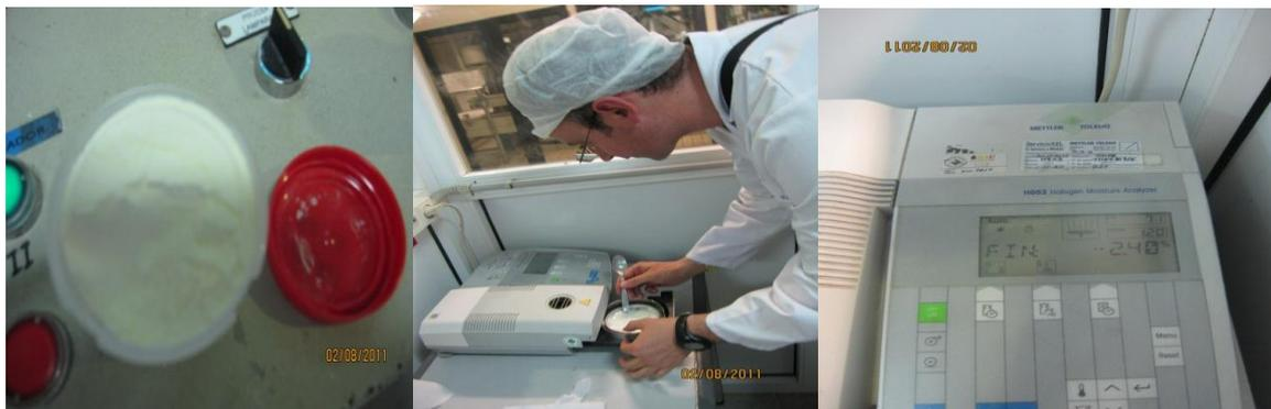
Fotos 6.6, 6.7, y 6.8. Determinación de la humedad de una de las muestras
