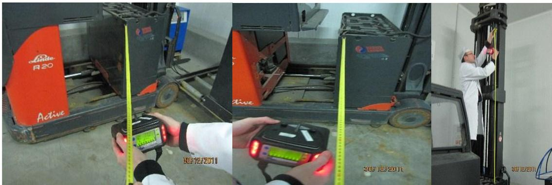
**Fotos 8.63, 8.64 y 8.65.** Mediciones de hidrógeno con el equipo dragüer a una distancia de 1,2 metros en sentido horizontal y de 2,4 metros en sentido vertical
