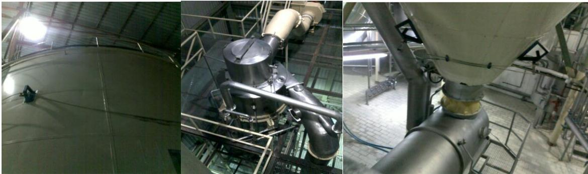
**Fotos 4.59, 4.60 y 4.61 (izquierda-dcha).** Martillos de impacto en el silo para evitar alpezamientos, conductos de secado en primera etapa del producto terminado y caída del producto seco en el cono de la cámara de secado al sistema vibrofluidificador
