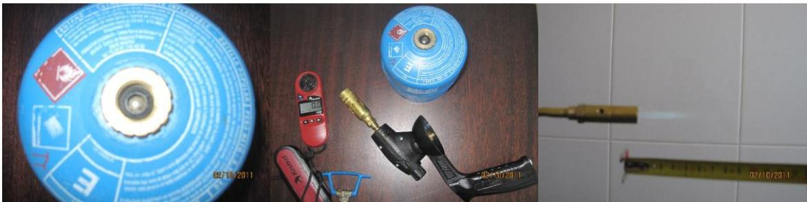
**Fotos 8.37, 8.38 y 8.39.** Elementos utilizados en el experimento y medida de la llama.
