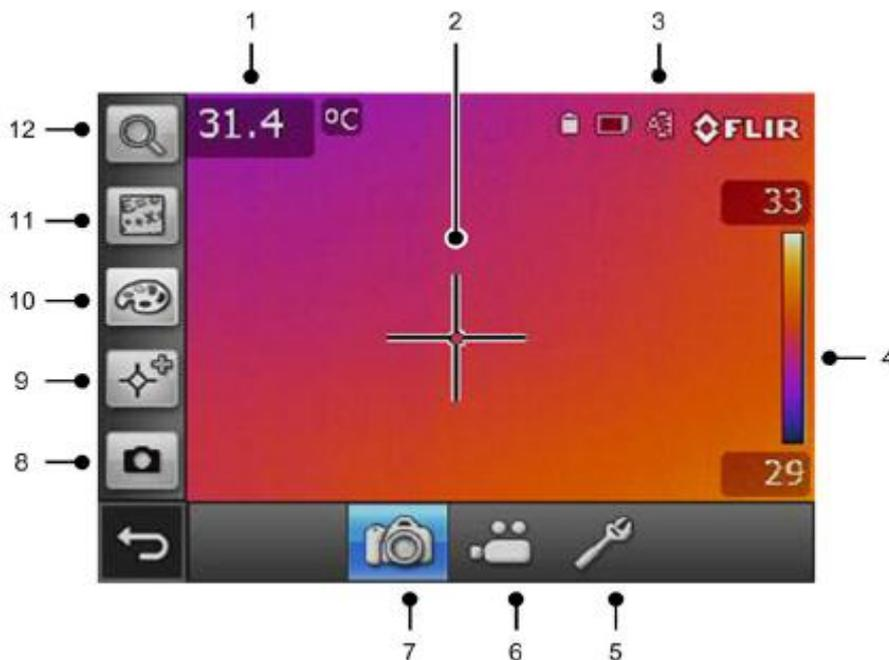
**Figura 7.25.** Elementos de la pantalla de la cámara FLIR E60
