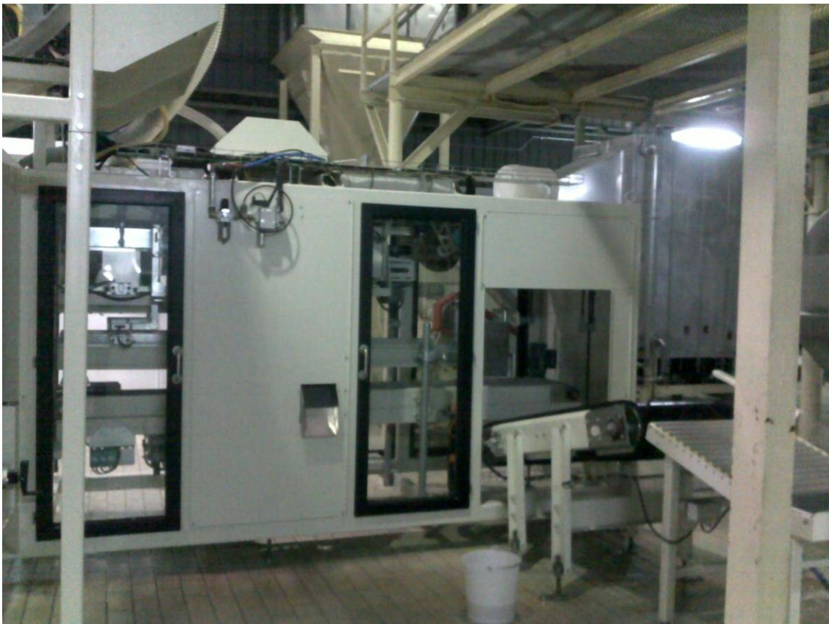
**Foto 4.62.** Panel posterior de la estructura que apoya y protege a los dispositivos de ensacado
