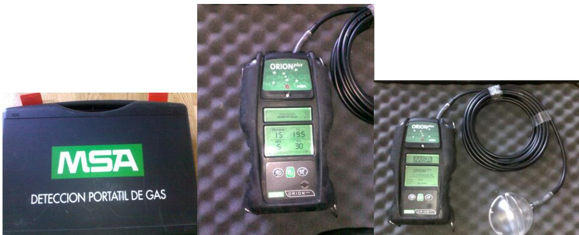
Fotos 5.1.-5.3. Equipo Orion<sup>plus</sup> de MSA para la detección de gases
