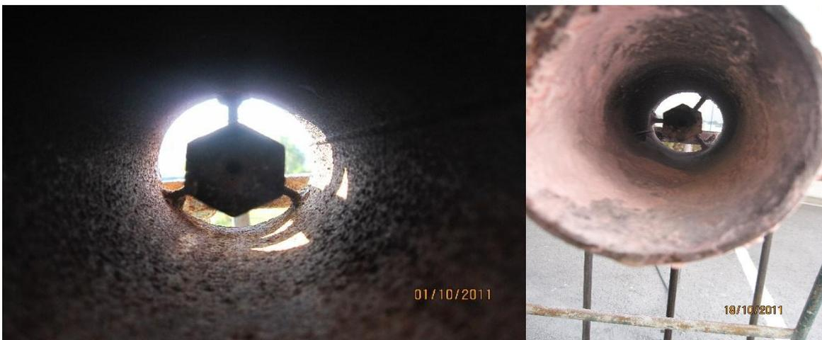
Fotos 8.44 y 8.45. Orificio de escape de gas de diámetro 3mm en interior tobera
