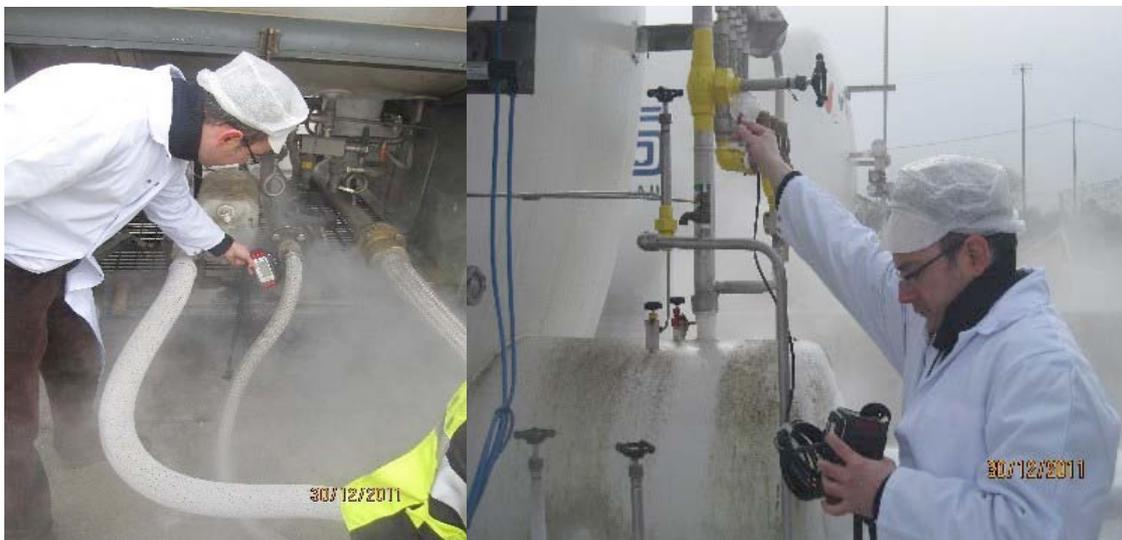
Fotos 10.1 y 10.2. Mediciones de gas realizadas durante la descarga
