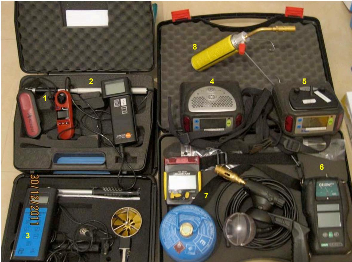
**Foto 11.1.** Equipos utilizados (1. Termohigrómetro Kestrel K 3000, 2 Anemómetro de sonda tipo molinete testo term modelo 440, 3 Anemómetro Termómetro Higrométrico Digital Pacer modelo DA 40H, 4 y 5 Explosímetro dragüer Xam 7000, 6 Explosímetro Orion, 7 Botella de gas butano de 0,5 kg, 8. Botella minigas Botella Minigas 100 Rothenberg Industrial de 150 ml (30% butano y 70% propano)
