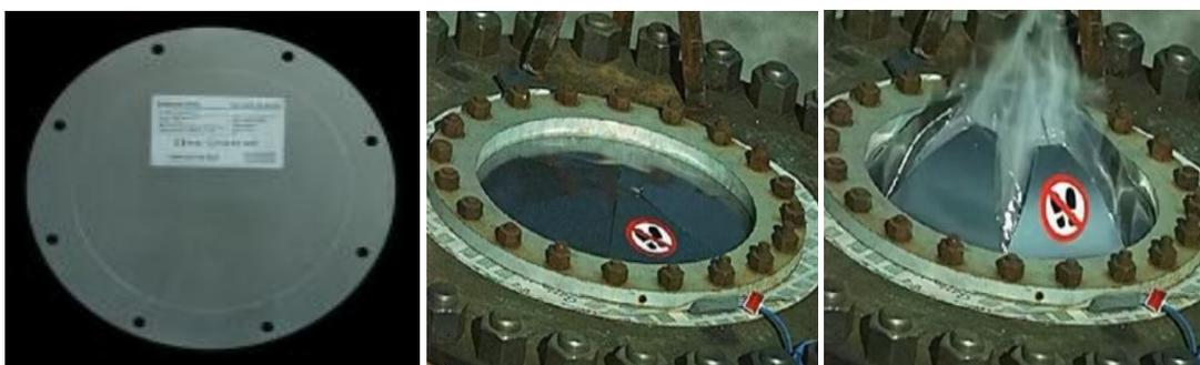
**Figura 8.100 y fotos 8.88 y 8.89.** Paneles de venteo circulares (Adix y Fike Ibérica)
