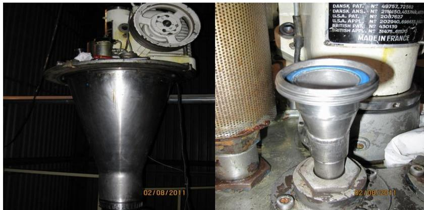
Fotos 8.79 y 8.80. Atomizado (izq) y embudo de entrada de leche (derecha)
