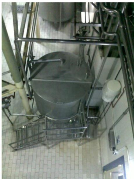
**Fotos 4.15 y 4.16.** Conducción de la leche concentrada a la parte superior de la torre
