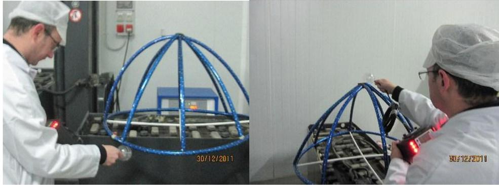
**Fotos 8.61 y 8.62.** Mediciones de hidrógeno con el equipo dragüer sobre una esfera de 35 cm colocada sobre uno de los tapones de la batería
