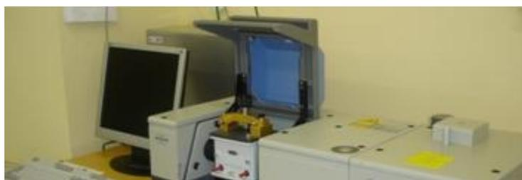
*Figura 31<sup>o</sup>. Espectrofotómetro de IR medio BRUKER VECTOR 22.*
