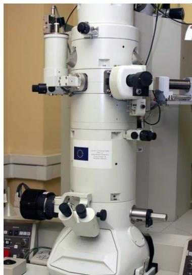
**Figura 33<sup>9</sup>.** Microscopio electrónico de transmisión, JEOL JEM 1010.
