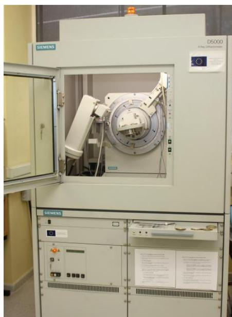
*Figura 30<sup>o</sup>. Difractómetro D5000 Siemens.*
