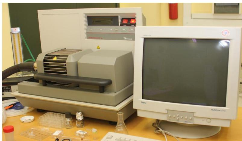
**Figura 32<sup>o</sup>.** Analizador simultáneo ATG-ATD ThermalAnalysis SDT2960.
