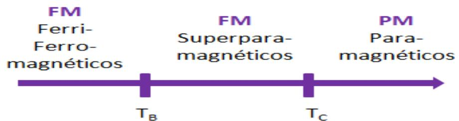
**Figura 6** Variación del comportamiento magnético en partículas monodominio según el incremento de temperatura. ( $T_B$ =temperatura de bloqueo – temperatura de transición entre comportamiento ferrimagnético o ferromagnético y superparamagnético-,  $T_C$ =temperatura de Curie – temperatura de transición al comportamiento paramagnético).
