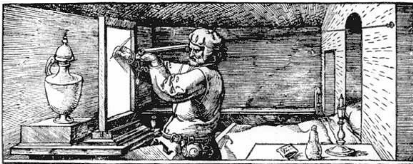
1. Instrumento perspectivo conocido como “Instrumento de Keser”: mirilla con punto fijo en la pared y panel de vidrio. Underweysung , segunda edición, Nuremberg (1538). El método sustituye el ojo por un clavo en la pared, al cual se fija una cuerda, en cuyo extremo libre está la mirilla con un punto de mira similar al de un fusil: los puntos característicos del modelo que se marquen sobre el cristal vendrán determinados no por la posición real del observador, sino por la del clavo de la pared
