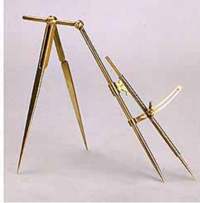
1. Leonardo da Vinci (1452-1519). Compás de elipses. Reconstrucción en latón según dibujo de Lorenzo y Benvenuto della Volpaia 1 , Libro di macchine diverse , 1520-24. MHC.
