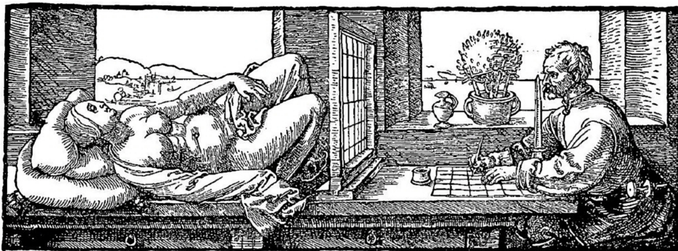
2. Grabado de Alberto Durero donde se aprecia el uso del velo albertiano Instrumento perspectivo: mirilla y ventana con retícula. El ojo del observador mantiene fija la posición gracias a la mirilla. Entre ella y la modelo se coloca un marco de madera que incorpora a modo de ventana una cuadrícula de hilos. El dibujante transcribe la información que percibe uno de sus ojos a una cuadrícula semejante preparada en la hoja de dibujo. Underweysung , Segunda Edición, Nuremberg (1538).
