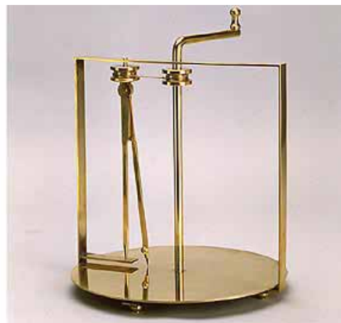
3. Leonardo da Vinci. Compás para epicicloides. Reconstrucción (del Códice Arundel) en latón. MHC
