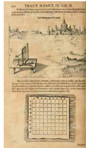
1, 2 y 3. Distintas páginas del tratado de Rober Fludd, Tractatus de naturae (1618), en las que se explica la manera de realizar un dibujo del natural, auxiliado por la cuadrícula (la vertical transparente, y la horizontal opaca) y un visor.
