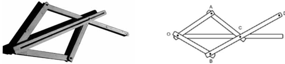
6 y 7. Elipsógrafo de cuadrantes y esquema geométrico de su funcionamiento. MHM.
