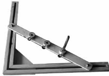
1 y 2. Elipsógrafo de Cardano y esquema geométrico de su funcionamiento. MHM.
