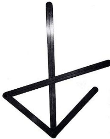
2. Leonardo da Vinci (1452-1519). Página manuscrita del Códice Atlántico e instrumento para calcular el ángulo de reflexión de un rayo de luz que incide sobre la superficie de un espejo cilíndrico, utilizado por el propio Leonardo para resolver el denominado “Problema de Alhazen”. Si en lugar del rayo de luz se imagina el rayo visual, la herramienta puede ser utilizada para la construcción de anamorfosis cilíndricas. Reconstrucción en madera de cerezo según los apuntes de Leonardo en el Códice Atlántico. MGF.
