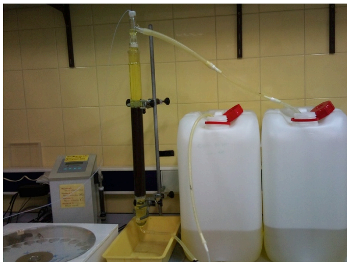
Figura 2.14 Experimento en columna con disolución de Cr(VI).
