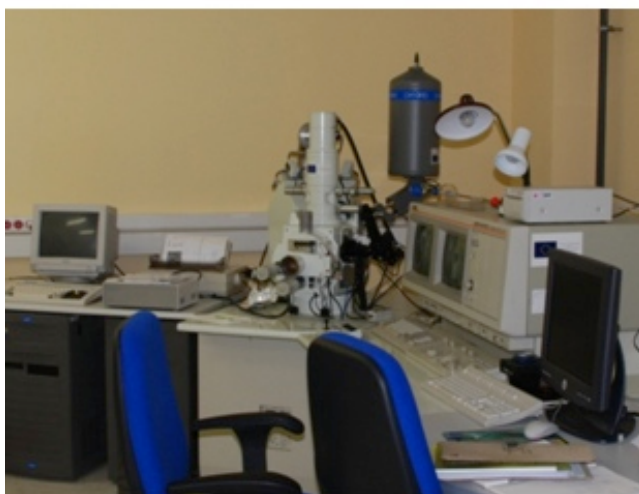
Figura 2.10 Microscopio Electrónico de Barrido Modelo JEOL JSM 6400.
