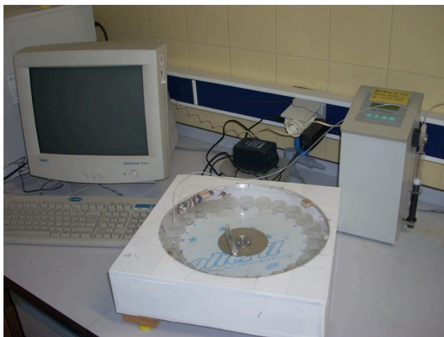
Figura 2.17 Muestreador automático para la toma de muestras durante la realización de los experimentos en columna.
