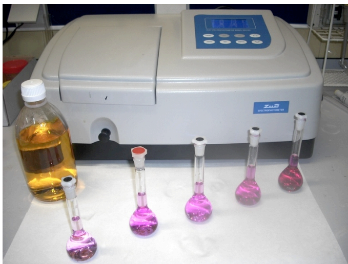
Figura 2.3 Espectrofotómetro Zuzi 4210/20 y disoluciones de calibrado para la determinación de Cr(VI).
