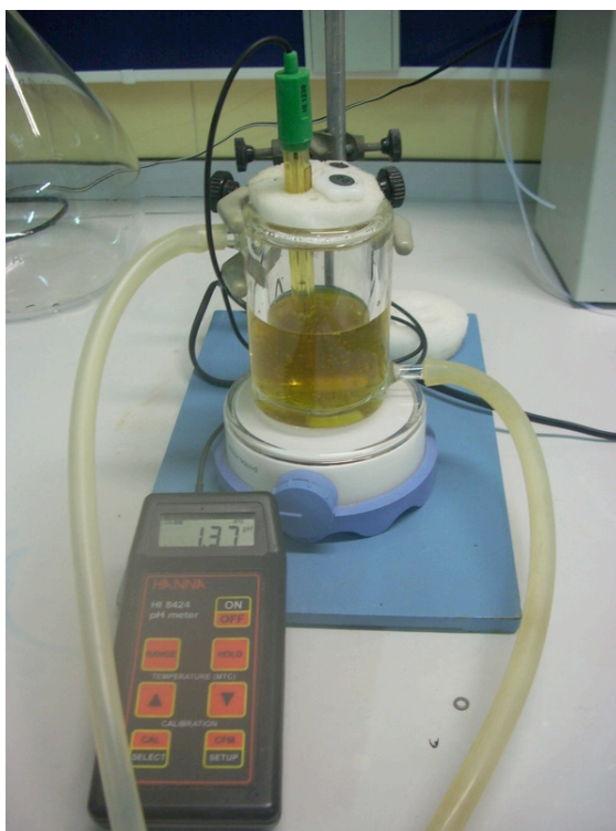
Figura 2.19 Montaje experimental para la realización de estudios cinéticos.
