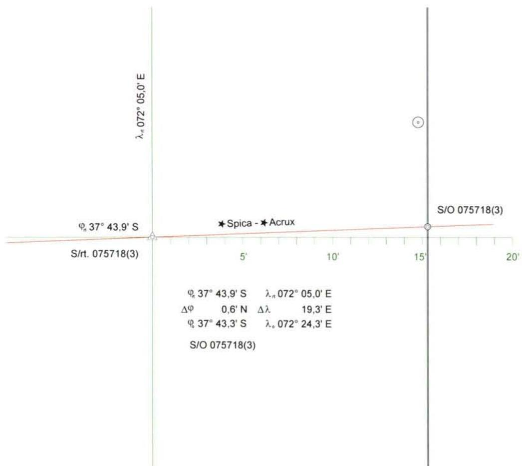
Figura - 1.501.C - Corte con recta de altura ☉
