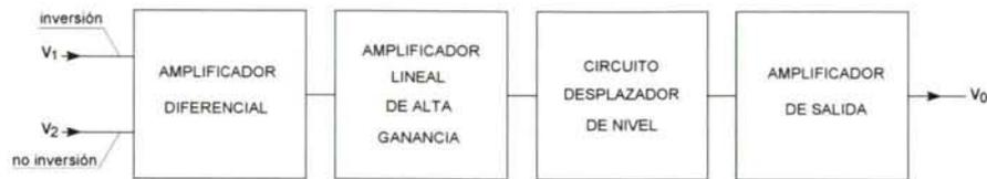
Figura - 1.168.VIII - Diagrama de bloques de un AO
