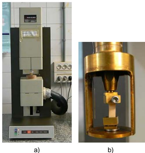
**Figura 2.7** (a) Analizador dinamomecánico DMA7 y (b) geometría extensión-film.
