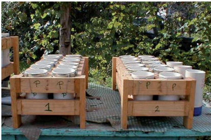
Figura 7.2.2.2: Foto de columnas de lixiviación conformadas con horizonte A y Bt.
