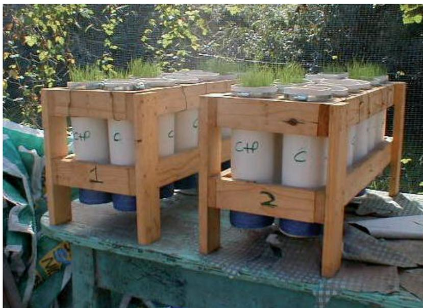
Figura 7.2.2.3: Foto de columnas de lixiviación conformadas con horizonte A + Bt + BC.
