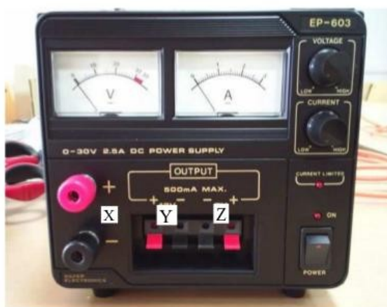
Figura 6.127.- Fuente de alimentación de Corriente Continua (DC) disponible en el Laboratorio
