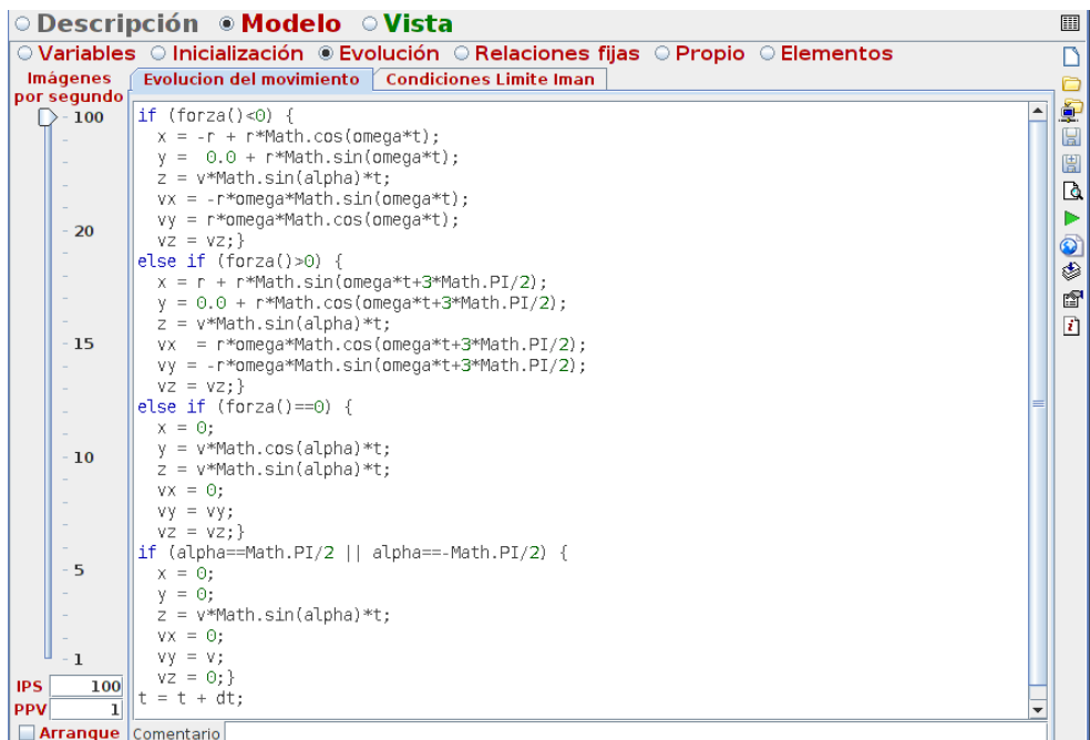
Figura 5.07.- Código Java para la "Evolución", con ejemplo práctico: velocidad y aceleración de un objeto en caída libre sobre un plano inclinado
