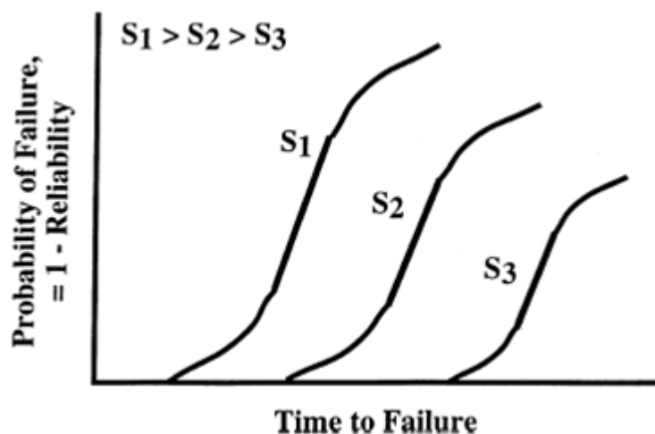
Figura 4.19 Probabilidad de fallo con diferentes niveles de tensión
