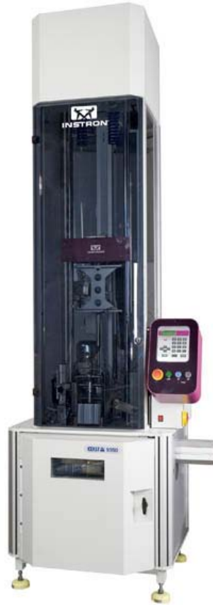
Figura 3.16. Equipo de tipo “falling weight” empleado y disposición de probeta SENB en ensayo de fractura dinámica.
