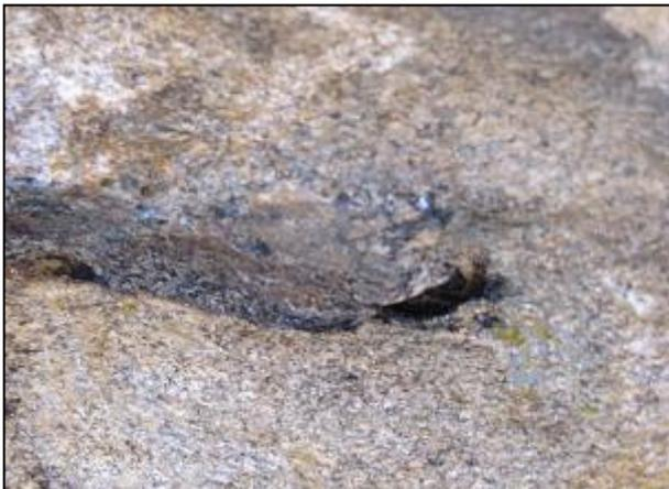
Fig.5.25. Inicio de una cavidad centimétrica en granito de Baroña aprovechando un schlieren. Las cavidades están asociadas a concentraciones de biotita, mineral que se altera fácilmente y que podría dar direcciones de debilidad por donde avanzaría la meteorización. También se pueden explotar xenolitos que han dado concavidades de forma y dimensiones comparables a xenolitos aún intactos.
