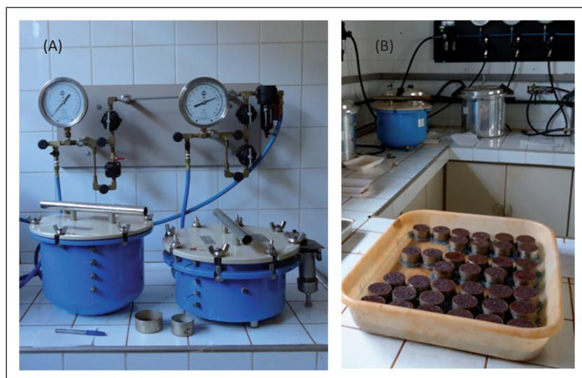
**Figura 20.** Equipo Richards (A) Extractor (olla presión) conteniendo en su interior las placas cerámicas de Richards, (B) las muestras de suelo en proceso de saturación, iniciando la determinación de la retención de humedad en los suelos.
