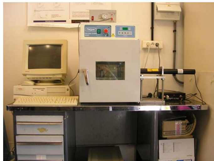
Figura 2.14: Aparato de medición de luz transmitida acoplado a un láser de He-Ne
