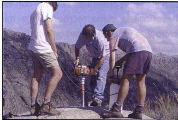
Fotografía 3.1. Extracción de una muestra (X-1) mediante el taladro de roca portatil
