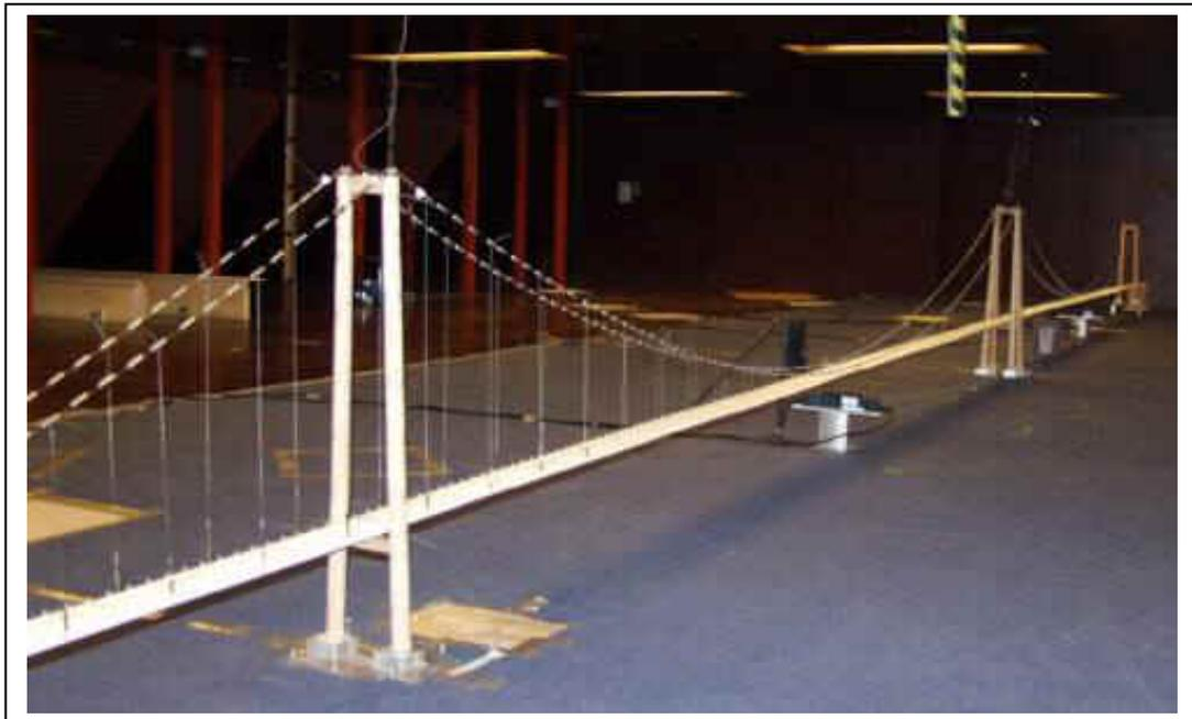
Figura 2.4.4. Modelo completo del puente sobre el canal de Chacao
