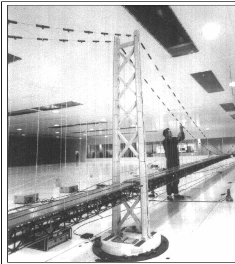
Figura 2.4.5. Modelo completo del puente sobre el estrecho de Akashi a escala 1/100
