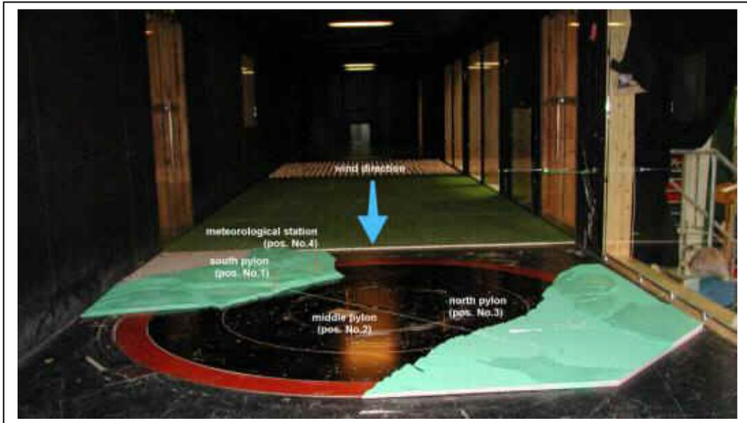
Figura 2.4.3. Modelo del terreno a escala 1/2000 realizado para el puente de Chacao en Chile.
