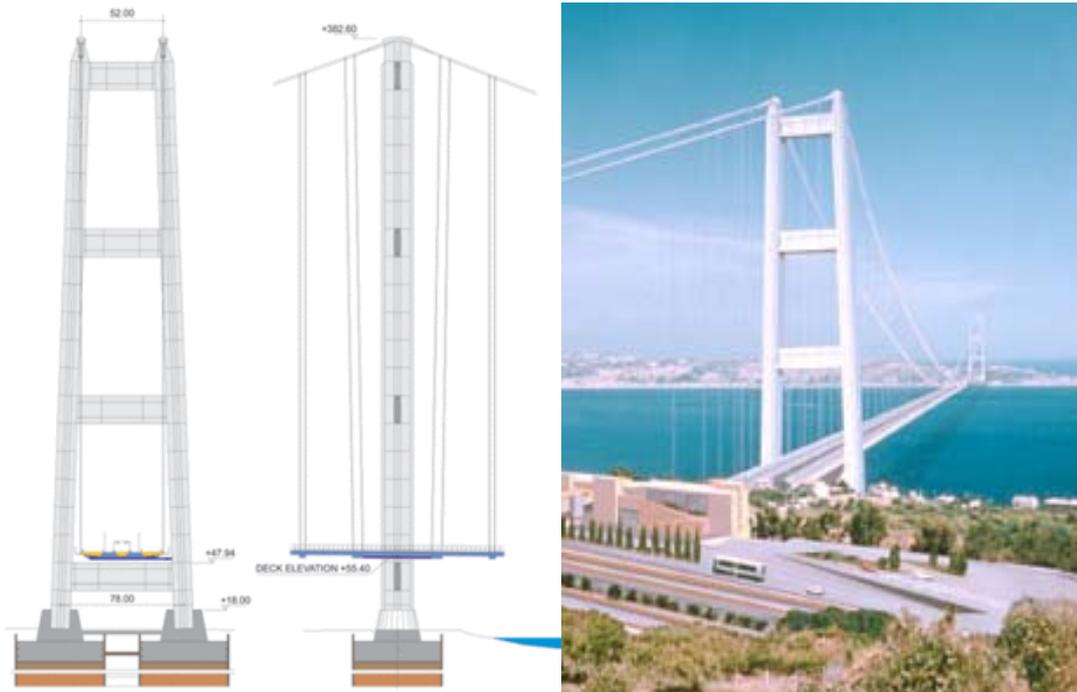
Figura 7.2.2(III). Detalle de las torres del puente de Messina.
