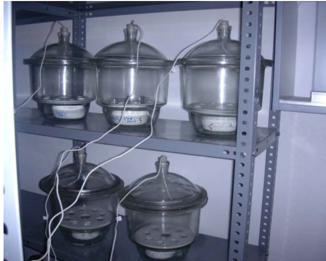
FIGURA 3.5. Aspecto de una parte de la batería de campanas de desecación empleadas en los ensayos de determinación de la curva de retención de los serrines de granito. El cable que sale de cada una de las campanas está conectado a un psicrómetro para la medida en continuo de la succión y la temperatura
