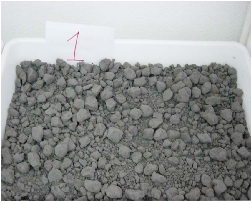
FIGURA 4.2. Aspecto de los serrines de granito (muestra tipo M1) tras un periodo de exposición al aire en el laboratorio. Los fragmentos más grandes que se observan en la imagen tienen un diámetro aproximado de 3 cm y se disgregan en polvo al ejercer una moderada presión con los dedos.
