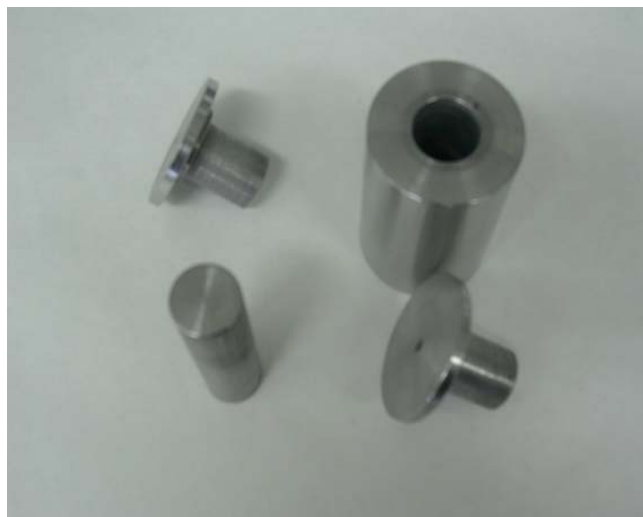
FIGURA 3.6. Vaso de compactación de las probetas de serrín. El diámetro del cilindro es 1 cm y el volumen de la probeta compactada de 2.12\text{ cm}^3 .
