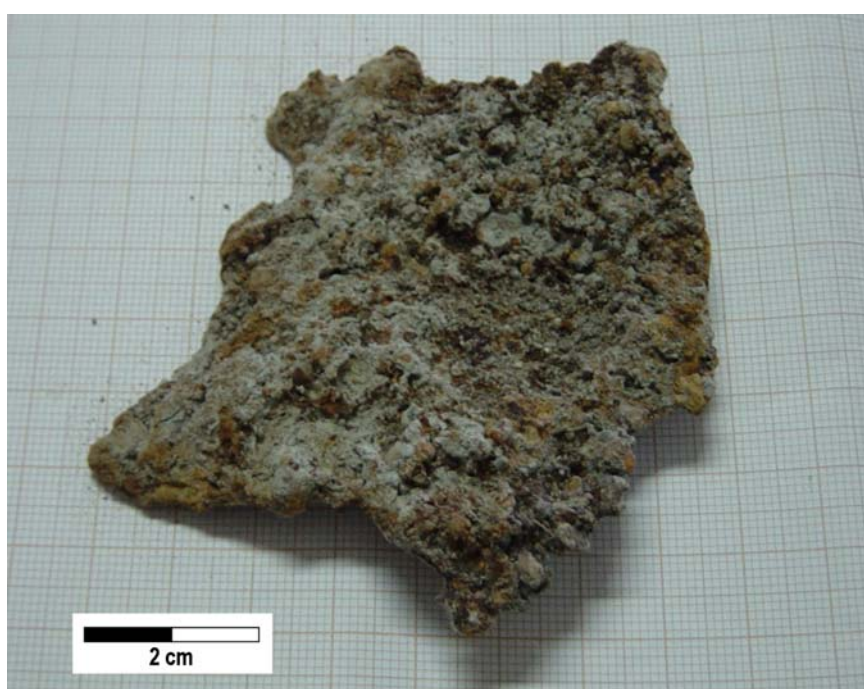
FIGURA 4.3. Costra de óxihidróxidos de Fe formada a partir de la oxidación de la granalla presente en los serrines cuando estos son expuestos a la atmósfera, manteniendo altos contenidos de humedad.
