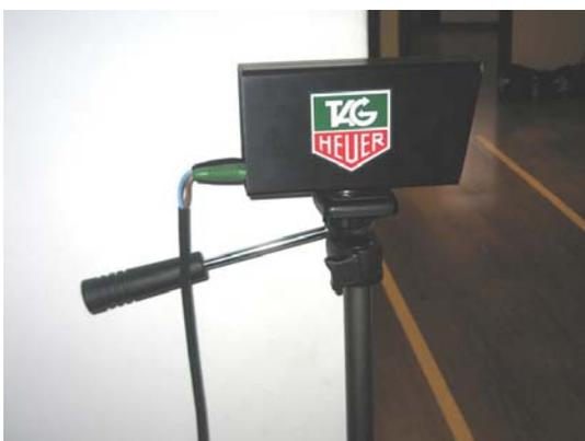
Figura 15. Focélulas Heuer (HL2-11), utilizadas para la prueba de la marcha.
