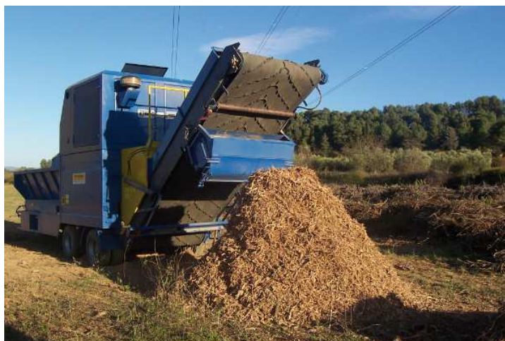
Figura 7 Subproducto de la vendimia para obtener energía en caldera de biomasa
