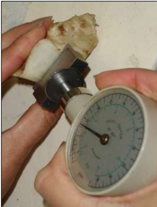
Fotografía N° 9. Penetrómetro con cuchilla de corte
