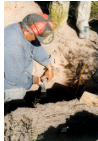
Figura 5. Extracción de una muestra con el método del cilindro para determinar densidad aparente.
