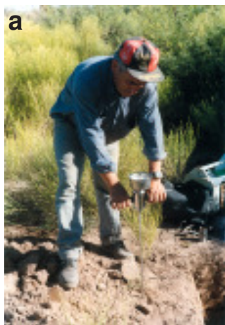
Figura 6. a) Aplicación del penetrómetro de cono Eijkelkamp para determinar la resistencia a la penetración; b) Perfil presiométrico.
