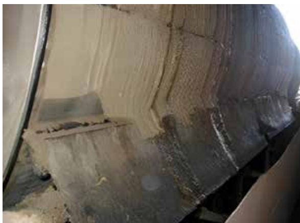
Figura 10.4. Produção de torta de filtro, em filtros rotativos, para extração da sacarose residual da borra no processo de clarificação do caldo.
