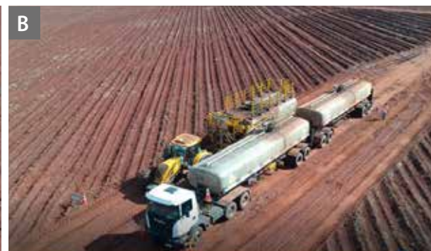
Figura 10.9. Aplicação localizada de vinhaça com trator (A) e transferência da vinhaça do caminhão para o tanque do trator (B).
