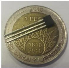
**Figura 10: Sensor 49e de efecto hall utilizado para medir la posición del elemento levitado.**
