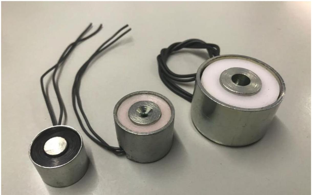
**Figura 8: Electroimanes tipo ventosa como el utilizado en el sistema.**
