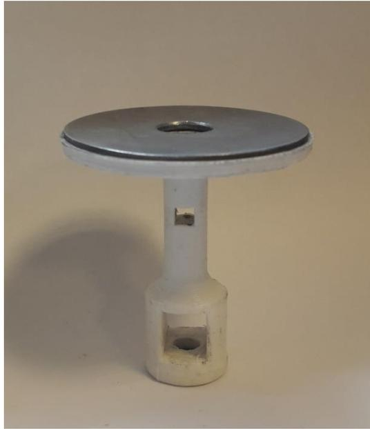
**Figura 9: Elemento levitado del sistema Levitador Magnético**
