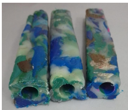
Figura 4 - Tubos de PEAD furados
