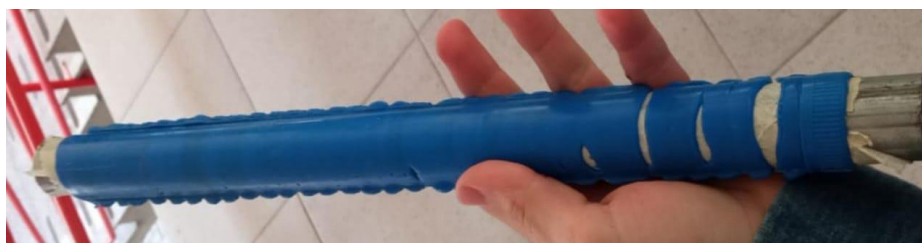
Figura 1 - Protótipo de tubo de PEAD no molde
