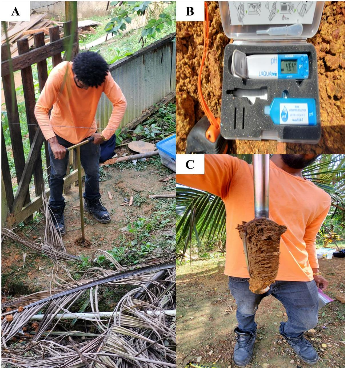
**Anexo 3.** A) Toma muestra con barreno. B) medición de pH en campo. C) Extracción de muestra de suelo para determinación de textura en laboratorio
