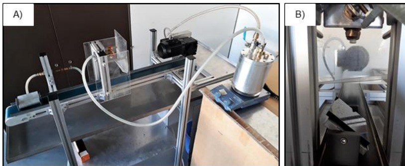
Abbildung 17: A) Applikationsapparat für die Beschichtung von Platten mit Kapselsuspension B) Platte auf einer Halterung zur Variation des Winkels unter der verwendeten Hohlkegeldüse
