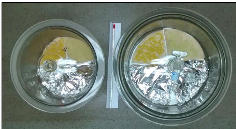
Abbildung 16: Hopfenextrakt-Kapseln in Exsikkatoren zur Untersuchung des Einflusses von Licht und Luft auf die Wirkstoffstabilität
