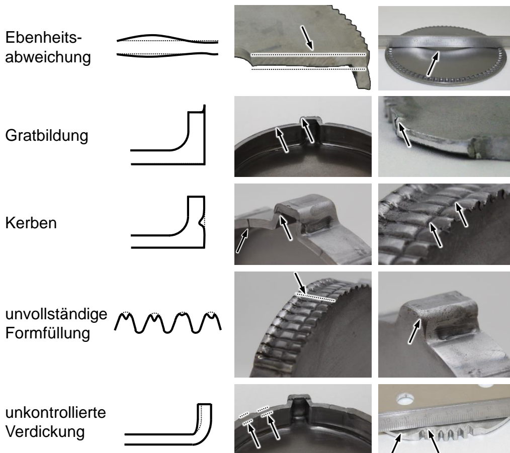
Abbildung 15: Messtechnisch relevante Fehlerbilder blechmassivumgeformter Bauteile
